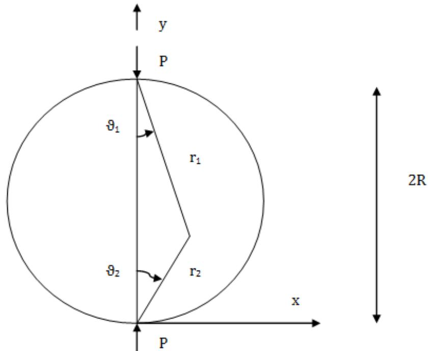
$$\sigma_x = -\frac{2P}{\pi} \left[ \frac{\cos\vartheta_1 \sin^2\vartheta_1}{r_1} + \frac{\cos\vartheta_2 \sin^2\vartheta_2}{r_2} - \frac{1}{2R} \right]$$
