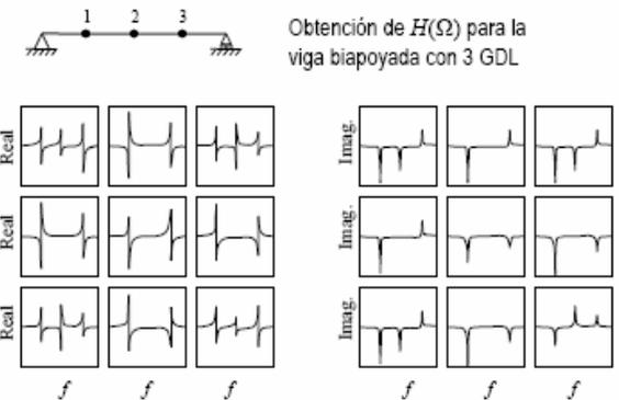
Las tres primeras frecuencias corresponden a los tres picos de las componentes de  $H(\Omega)$ . Las correspondientes formas modales se pueden dibujar a partir de la parte imaginaria de una sola fila o columna de  $H(\Omega)$ .
