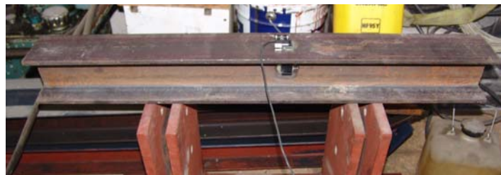
Fig. 3. Vista de la viga con el acelerómetro posicionado.
